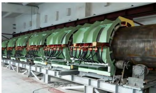
Рисунок 1 – Установка ВИК-14С для обработки деталей до 14 м и диаметром до 1200 мм [9]
