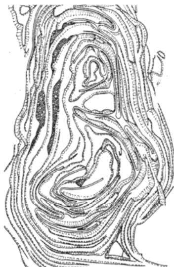
Рис. 2. Схема петлевых автомобильных съездов в карьере
