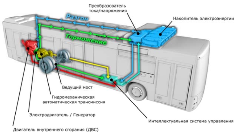
Рис. 10. Гибридная силовая установка городского автобуса
