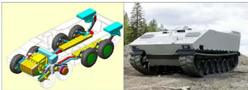
Рис. 7. Компоновка боевой машины с ГСУ (Великобритания)
