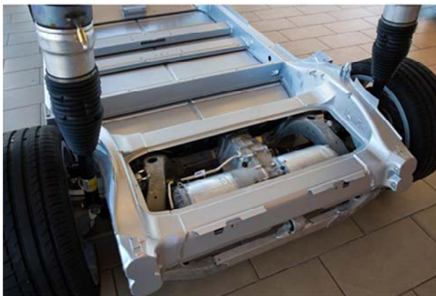
Рис. 4. Установка мотор-генераторов автомобиля компании "Тесла"
