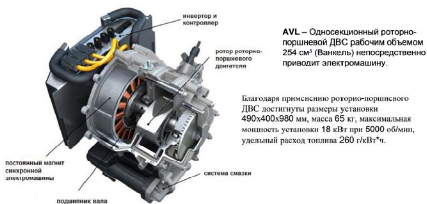
Рис. 5. Установка “Range Extender AVL” Австрия
