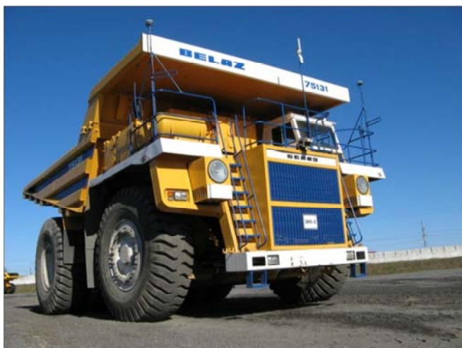
Рис. 3. Роботизированный самосвал БЕЛАЗ г/п 130 тонн
