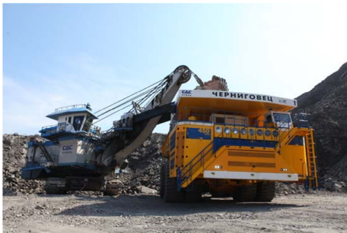
Рис. 4. БЕЛАЗ-75710 грузоподъёмностью 450 тонн
