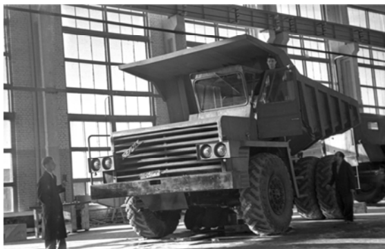
Рис. 1. Карьерный самосвал БЕЛАЗ-540 грузоподъемностью 27 тонн.
