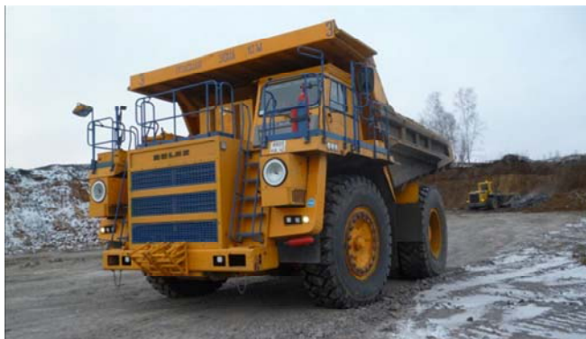
Рис. 2. Самосвал БЕЛАЗ-75581 грузоподъемностью 90 тонн
