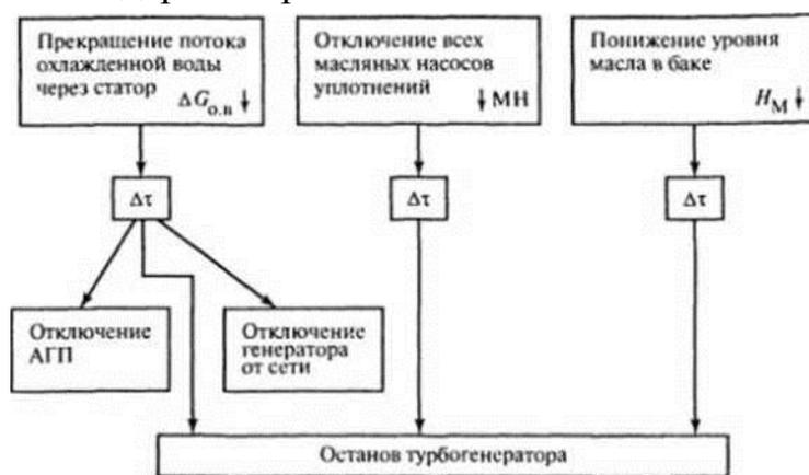
Рис. 7.10. Схема действия тепловых защит генератора
