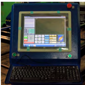
Рисунок 3 - Система ЧПУ трехкоординатного манипулятора
