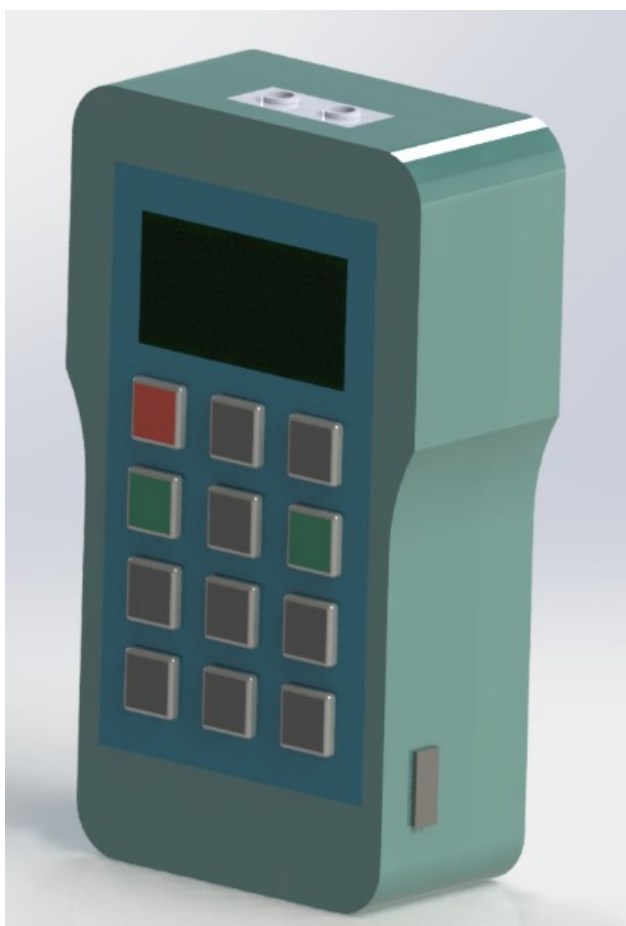
Рисунок.1 – Твёрдотельная модель ультразвукового толщиномера НА-95
