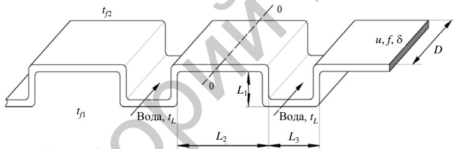
*Рис. 1. Принципиальная схема конструкции металличерепицы кровли животноводческого помещения*
