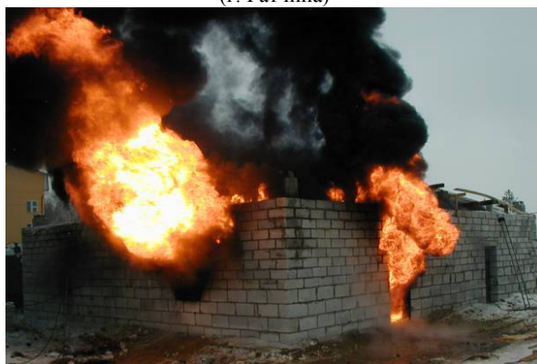
Рис. 3. Общий вид огневых испытаний фрагмента каркаса на стандартную пожарную нагрузку.
