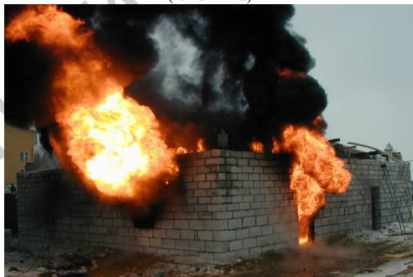
Рис. 2. Общий вид испытаний фрагмента каркаса при максимальной нагрузке (г. Гатчина)
