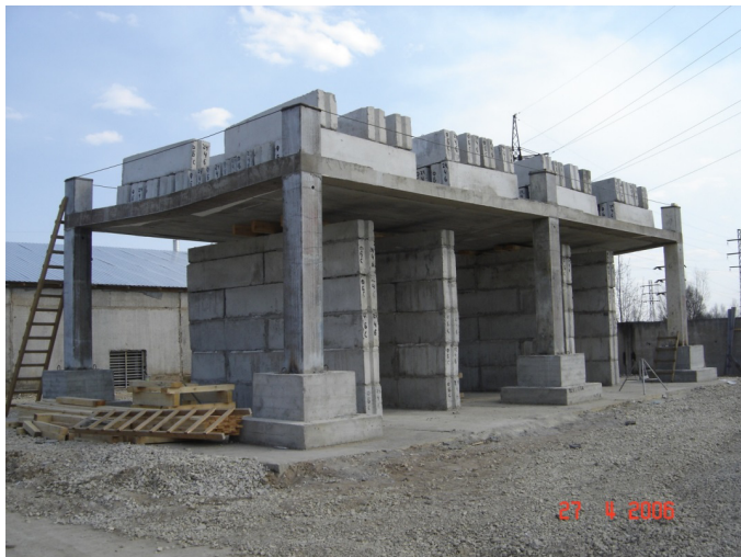
Рис. 2. Общий вид испытаний фрагмента каркаса при максимальной нагрузке (г. Гатчина)
