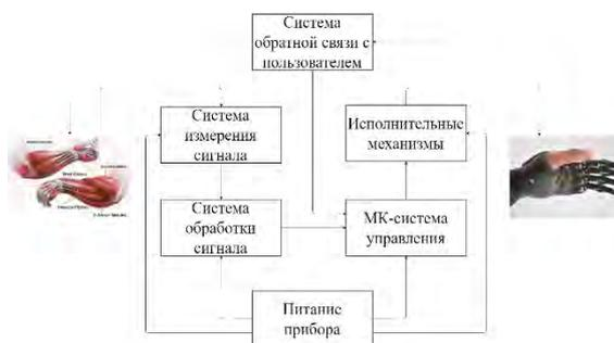
Рисунок 1 – Обобщённая схема бионического протезного устройства верхней конечности
