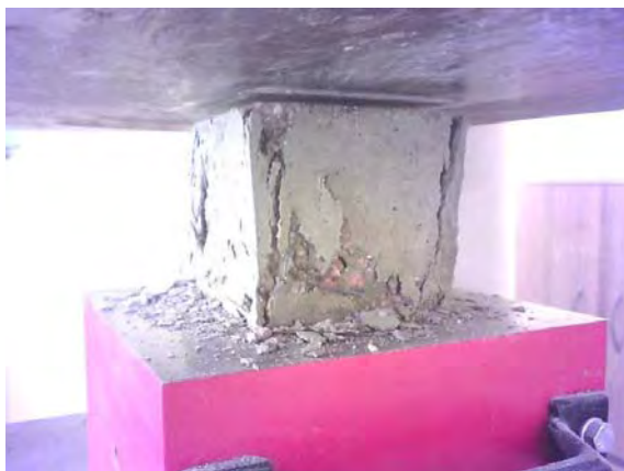
Рис. 1.35. Испытание образцов бетона на прочность при сжатии
