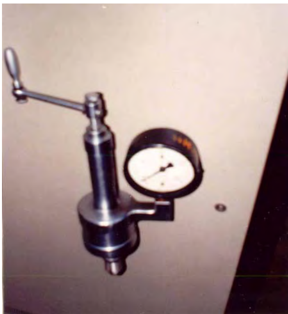
Рис. 2.29. Определение прочности бетона прибором ГПНС
