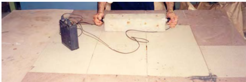
Рис. 2.21. Сквозное прозвучивание образцов прибором УК-14ПМ
