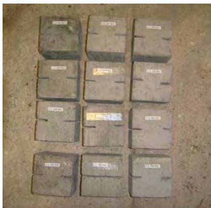
Рис. 1.29. Образцы–кубы с инициаторами трещин
