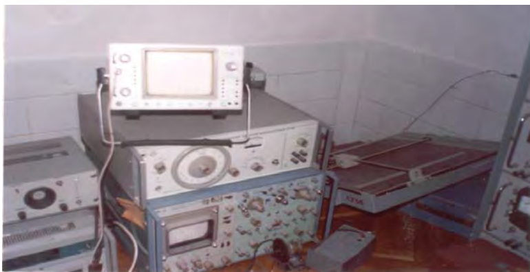
Рис. 2.23. Прибор ИЧМК для определения динамического модуля упругости
