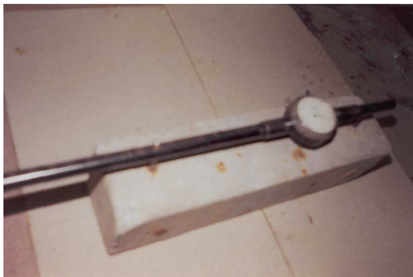
Рис. 2.28. Переносная мессура для определения деформации образцов
