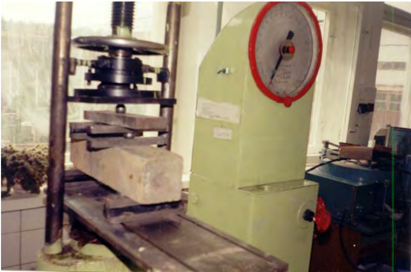
Рис. 2.20. Испытание образцов–призм на растяжение при изгибе
