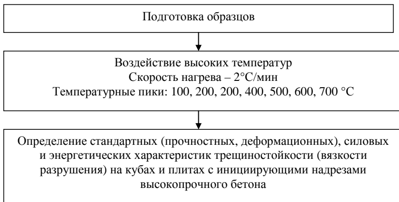
Рис. 1.22. Программа эксперимента определения остаточных характеристик бетона
