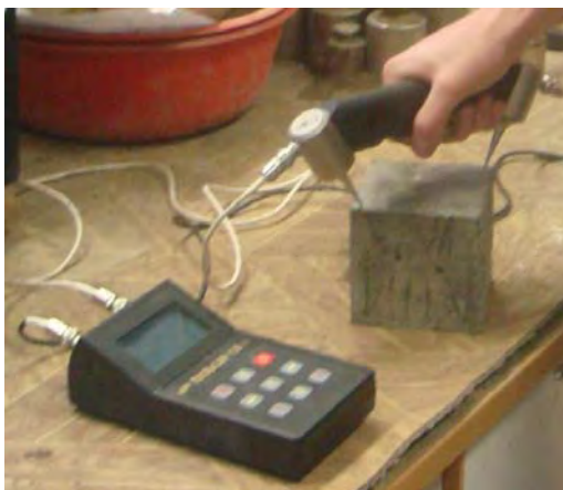
Рис. 1.28. Ультразвуковое поверхностное прозвучивание
