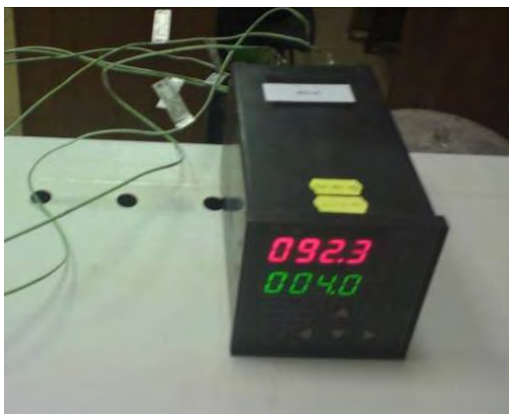
Рис. 1.24. Устройство контроля температуры «УКТ38»
