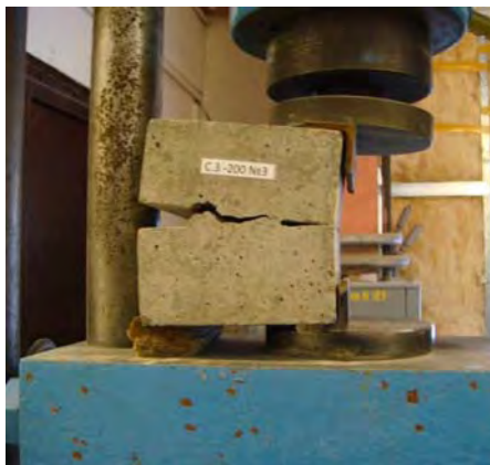
Рис. 1.31. Испытание образца на нормальный отрыв
