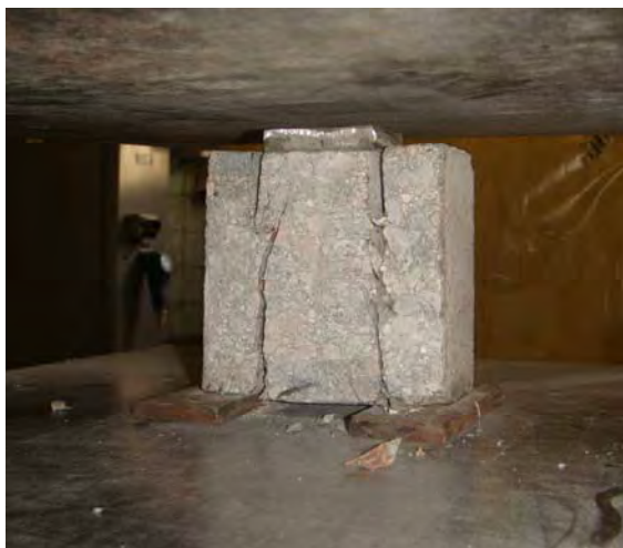
Рис. 1.34. Испытание образца на поперечный сдвиг
