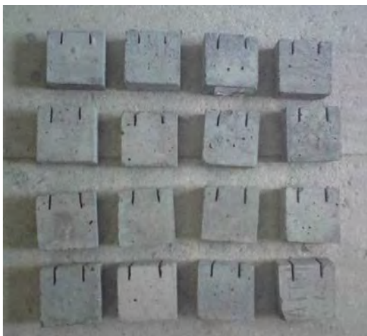
Рис. 1.33. Образцы 2-го типа с инициаторами трещин
