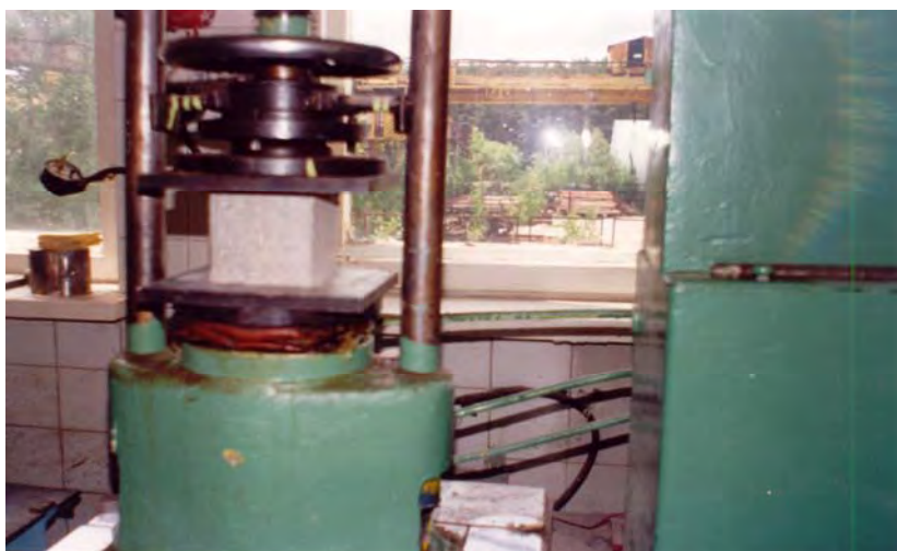
Рис. 2.19. Испытание образцов бетона на прочность при сжатии
