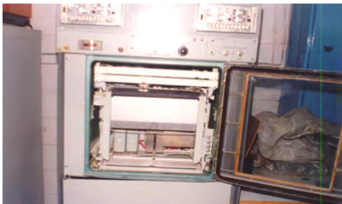
Рис. 2.26. Прибор КСП-4 для контроля температуры
