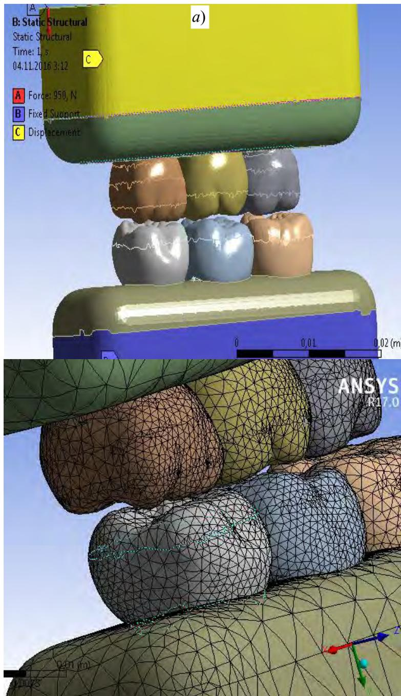
Рис. 1. Схема нагружения (а) и конечно-элементное разбиение модели (б)
