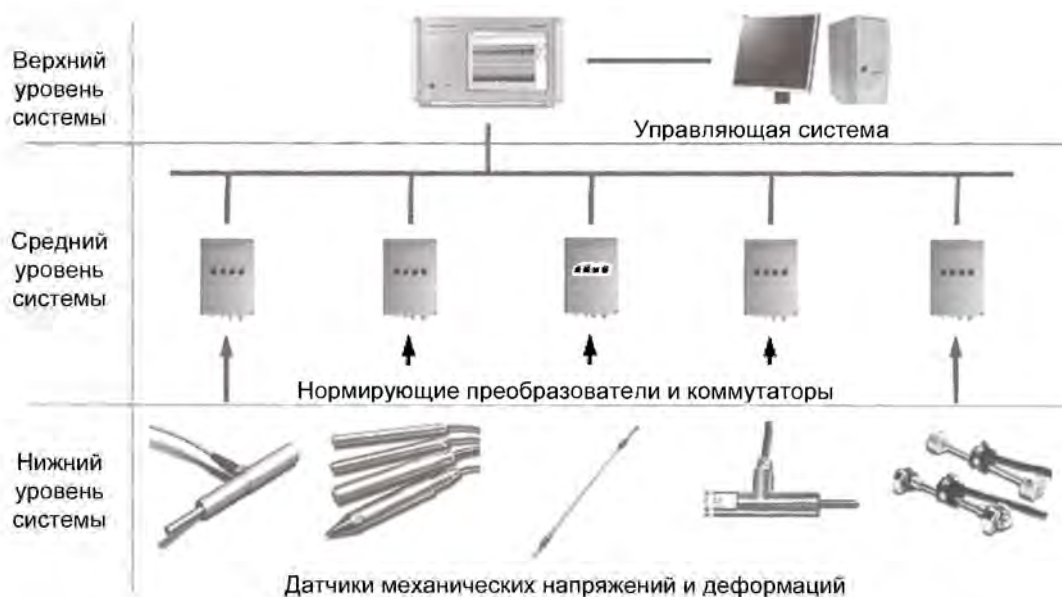
Рис. 2. Типовая структура системы строительного мониторинга
