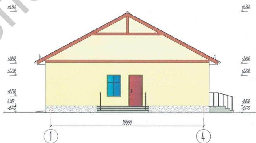
Рисунок 1 – Фасад здания одноквартирного жилого дома в осях 1-4
