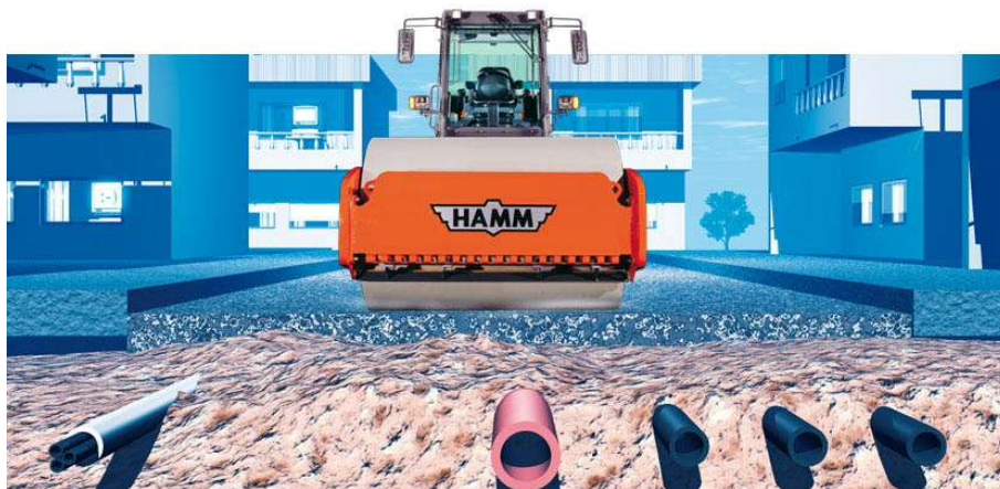
Рисунок 2 – Осцилляция не разрушает трубы
