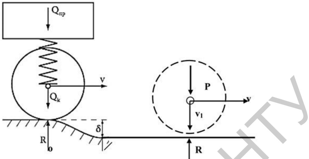
Рисунок 1 – Схема воздействия колеса автомобиля на дорожное покрытие в момент прохождения неровности
