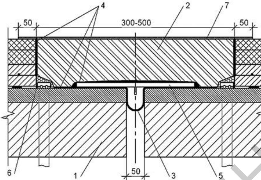
Рисунок 2 – Конструкция щебеноочно-мастичного шва, устраиваемого при ремонте: – мостового сооружения без замены конструктивных слоев мостового; – полотна. 1 – пролетное строение; 2 – щебеноочно-мастичное заполнение; 3 – резиновый лоток; 4 – мастика; 5 – металлическая пластина; 6 – дренажный элемент; 7 – слой износа
