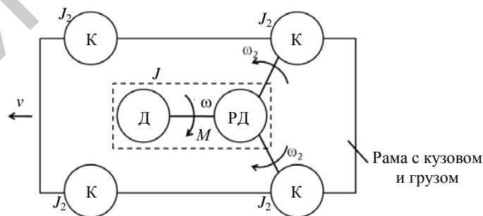
Рис. 3. Расчетная механическая схема электромобиля:  $v$  – линейная скорость движения автомобиля;  $M$  – момент тягового электродвигателя;  $\omega$ ,  $\omega_2$  – угловая скорость тягового электродвигателя с редуктором и колеса;  $J$ ,  $J_2$  – момент инерции тягового электродвигателя с редуктором и колеса; К – колесо; РД – редуктор и дифференциал; Д – двигатель
