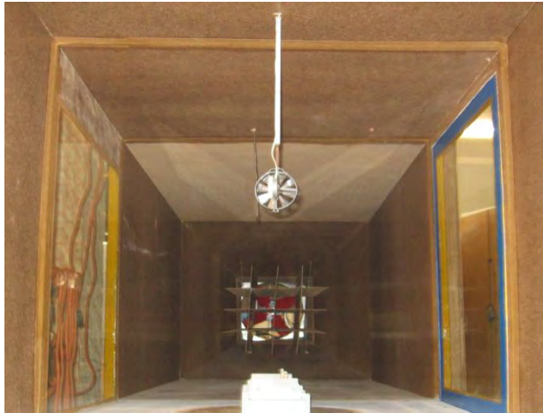
Рис. 10.2. Схема установки для аэродинамических испытаний модели здания: а – схема стенда; б – общий вид измерительного участка
