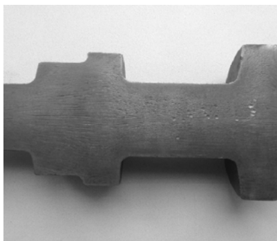
Рисунок 1 – Снимок макроструктуры прокатанной заготовки
