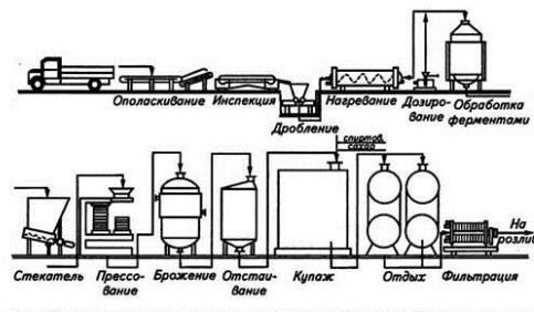
Рисунок 1 – Схема технологического процесса получения плодово-ягодных вин
