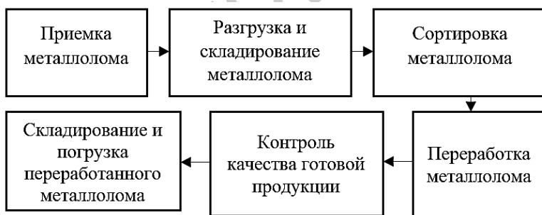
Рис. 1 – Принципиальная схема заготовки и переработки отходов и лома черных металлов на ОАО «Белворчермет»
