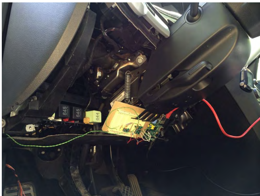
Рисунок 3 – Raspberry Pi работает с CAN шиной
