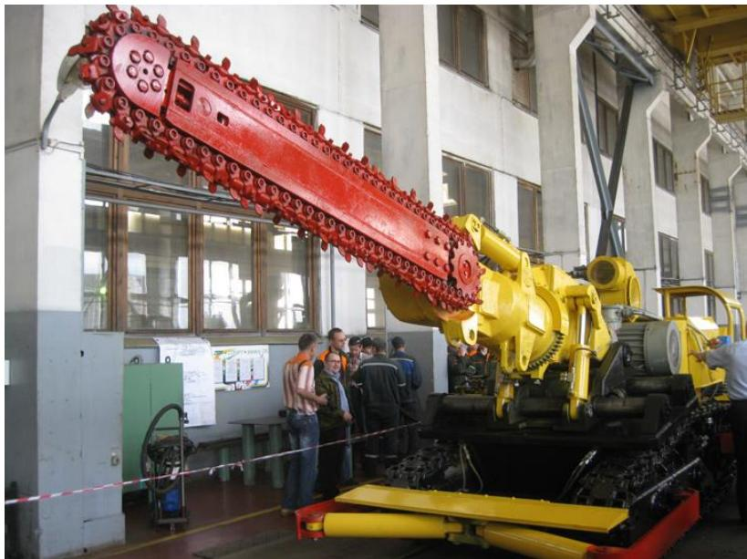
Рис. 1 – Общий вид щеленарезной машины МЗЩ-140
