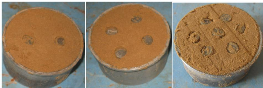
Рисунок 1. - Общий вид образцов песчаного грунта для сдвиговых испытаний с различным процентом их армирования (8 — 30%)
