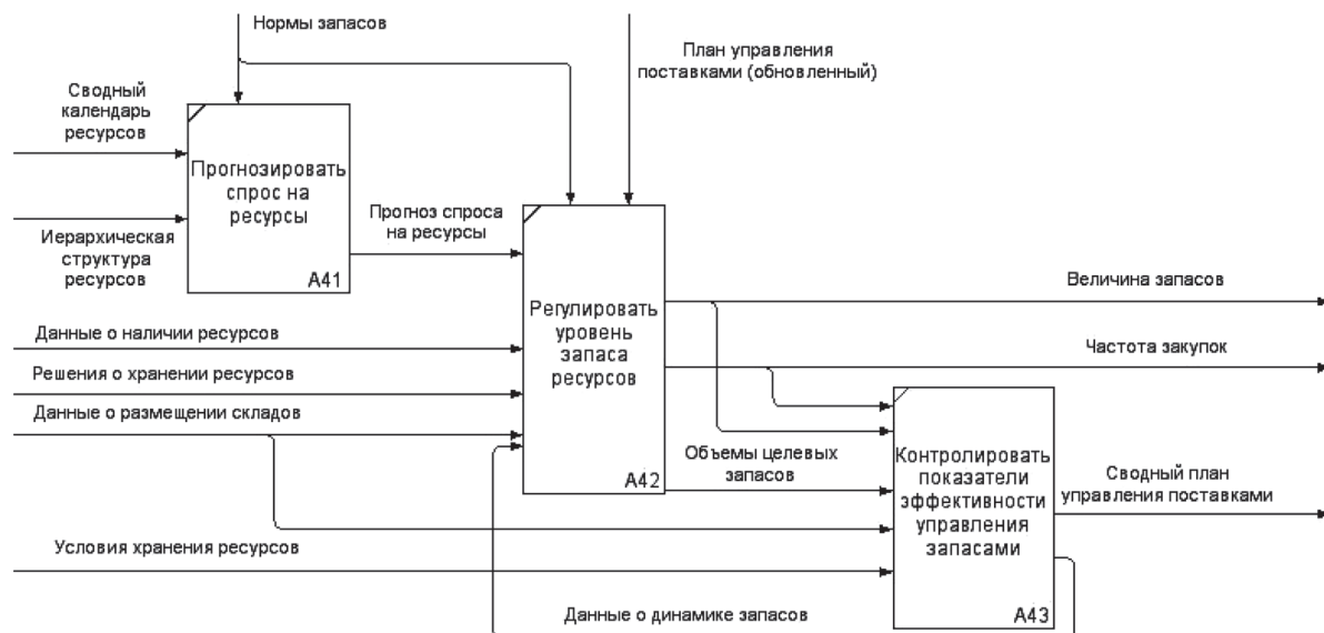
Рис. 3. Функциональная модель подпроцесса управления запасами ресурсов
