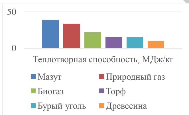
Рисунок 2. Теплотворная способность различных видов топлива
