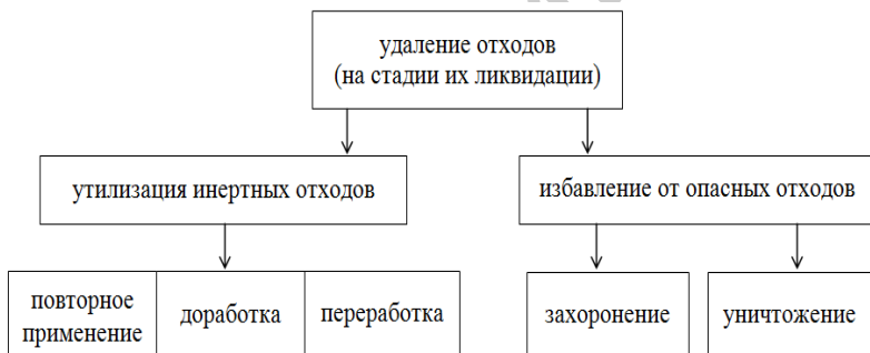
Рисунок 1 – Принципиальная схема удаления отходов
