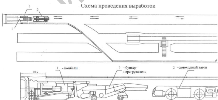
Рис. 1 – Размещение и движение самоходного вагона в шахте
