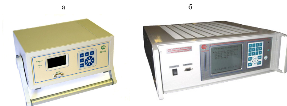
Рис. 2. Измерительные средства для испытания электроэнергетического оборудования: а – силовых трансформаторов – прибор ДСТ-1М; б – электрических машин постоянного тока – диагностический комплекс ИПЭМ
