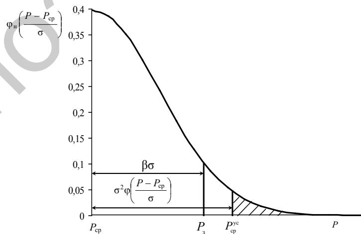
Рис. 1. Стандартизованная плотность нормального распределения
