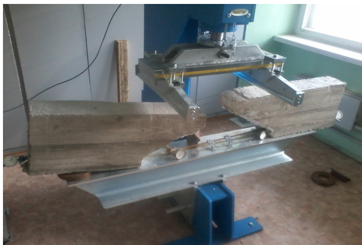
Рисунок 3 – Опытный образец после разрушения в результате разрыва арматуры
