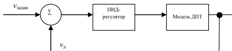
Рис. 1. Структурная схема системы регулирования скорости ДПТ
