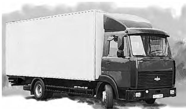
*Рис. 6. Среднетоннажный автомобиль МАЗ-4370*
