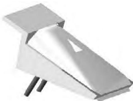
*Рис. 15. Компьютерная модель для оптимизации установки цилиндров опрокидывающего механизма самосвала БелАЗ грузоподъемностью 300-320 тонн*
