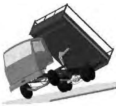
*Рис. 7. Исследование поперечной устойчивости среднетоннажного автомобиля-самосвала МАЗ*
