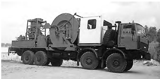
*Рис. 16. Агрегат ремонтно-технологический М-20 на базе шасси «МЗКТ-65271»*
