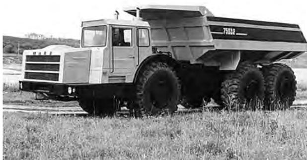
*Рис. 17. Внедорожный самосвал повышенной проходимости «МАЗ-75032»*
