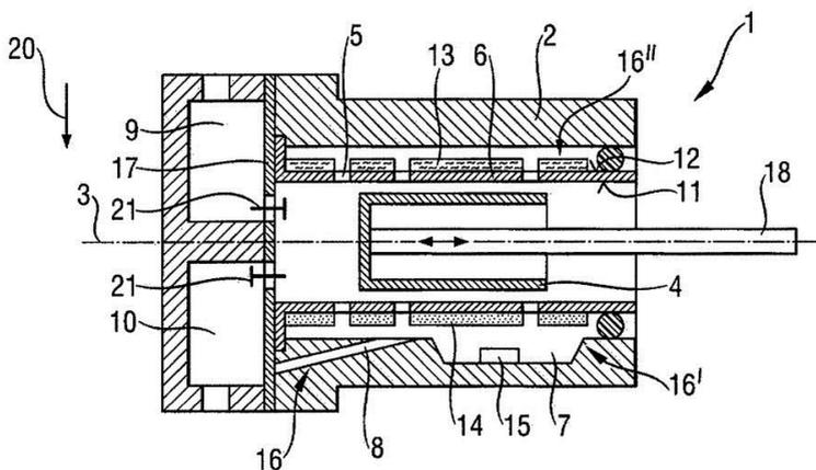
Рисунок 3 – Линейный компрессор
