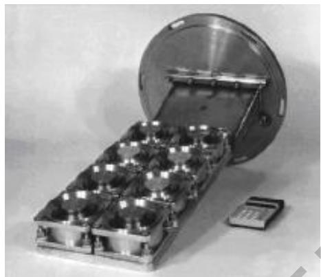
Рисунок 3 – Многокомпонентный электродуговой источник металлической плазмы
