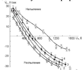
Рисунок 2 – Зависимость скорости конденсации от ускоряющего потенциала на подложке из стали Ст 3,  $P = 10^{-3}$  Па,  $J_i = 2,1 \pm 0,3$  мА/см<sup>2</sup>: 1 – Mo, 2 – Zr, 3 – Ti, 4 – Al, 5 – Ti
