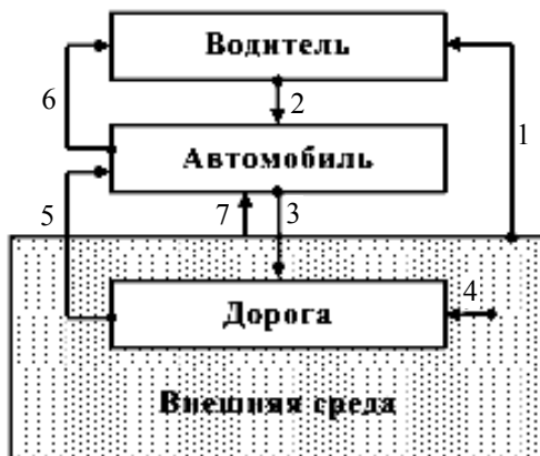
Рис. 2.1. Структурная схема системы эксплуатации автомобильной техники
