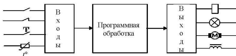
Рис. 1. Принцип работы ПЛК
