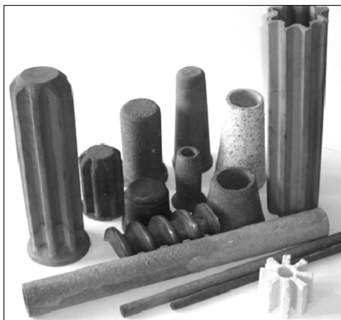
Рисунок 5.4 - Пористые порошковые материалы различной формы и размеров
