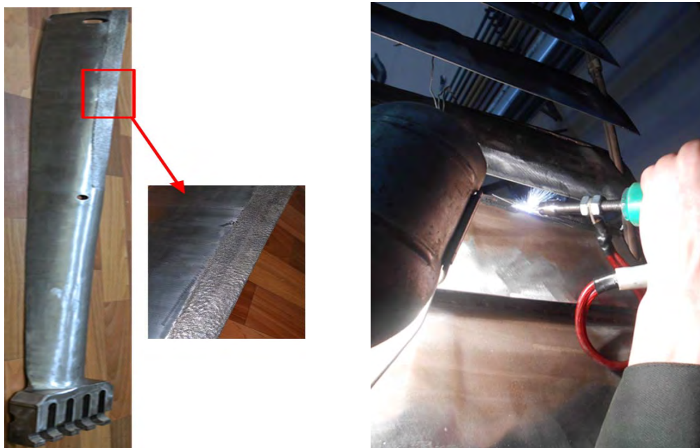
Рисунок 5.1 – Внешний вид лопатки паровой турбины с КМП на рабочей кромке и процесс нанесения КМП на облапаченном роторе, находящемся на опорах ремонтной площадки
