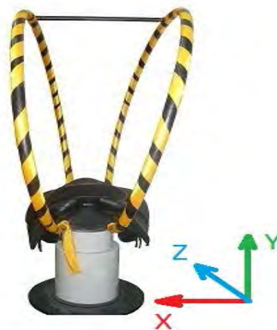
Рисунок 5 – Ориентация координатных осей тренажера при изучении направления распространения вибрации
