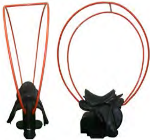
Поручни закреплены на приводе возвратно-поступательного движения
