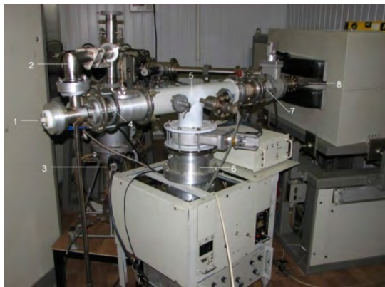
1 – капилляр, 2 – тракт откачки камеры капилляра, 3 – диффузионный вакуумный насос, 4 – вакуумный затвор, 5 – ионпровод, 6 – турбомолекулярный вакуумный насос, 7 – шелевой прибор, 8 – ионпровод ускорителя
