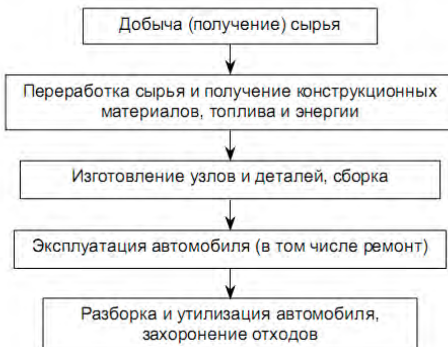
Рисунок 1.3 – Стадии жизненного цикла автомобиля
