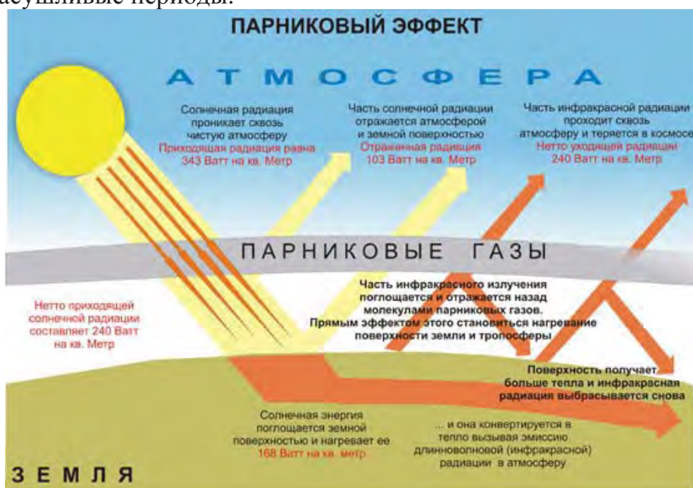
Рисунок 5.2 – Схема возникновения парникового эффекта
