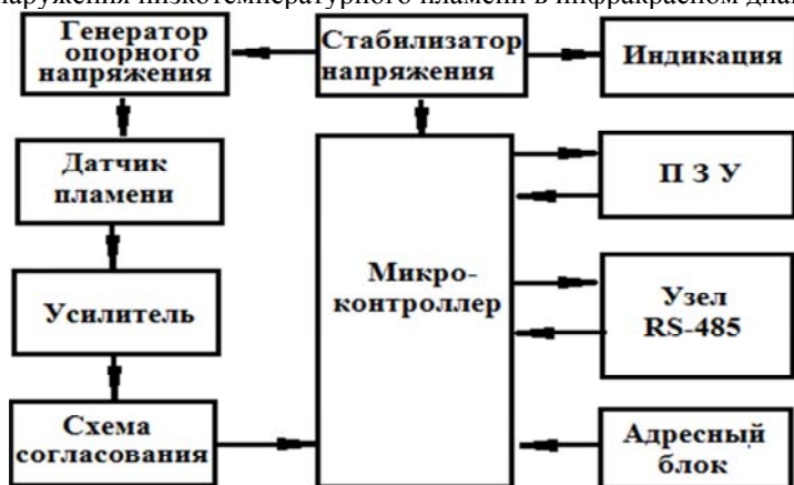
Рисунок 1. Структурная схема адресного модуля регистрации и обработки сигналов датчика пламени
