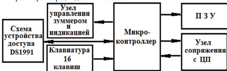
Рисунок 1. Структурная схема модуля ввода, контроля и регистрации данных
