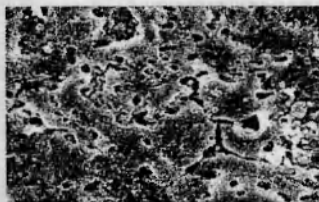
Рисунок 19 –Топография поверхности и фазовый состав покрытия на титановом сплаве ВТ 6, полученного в электролите ЭЩ 6 с гидроксидантитом и полирадикалами
