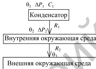
Рис. 2. Структурная схема тепловых процессов конденсатора
