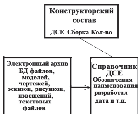
Рис. 2. Упрощенная структура БД большинства PDM
