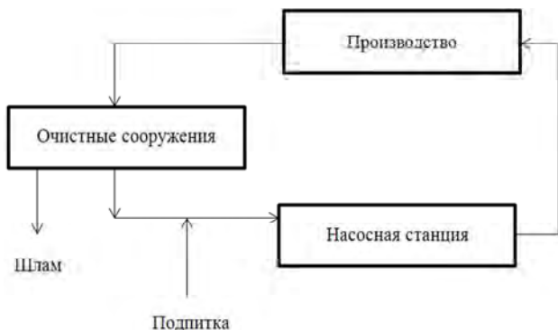
Рис. 9.12. Схема оборотного водоснабжения
