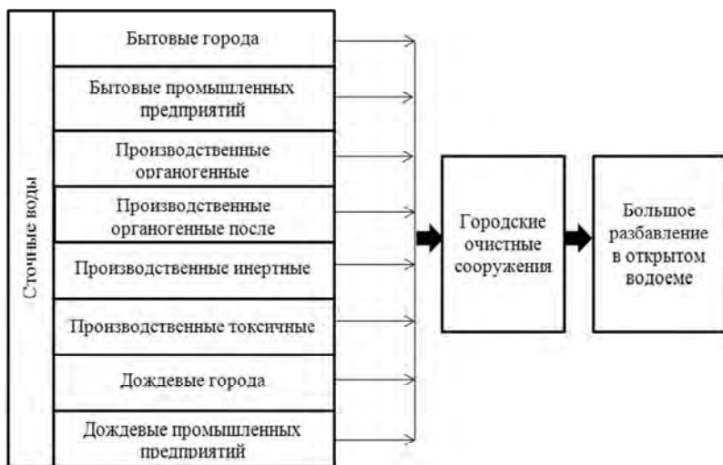
Рис. 9.11. Водоотведение для общесплавной системы
