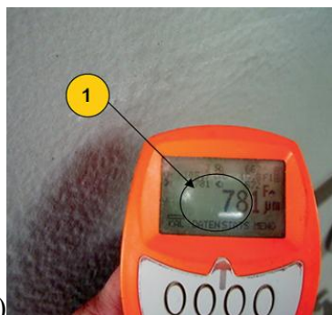
Рисунок 7А – Недостаточная толщина покрытия (1- номинальная толщина грунтовки 80 мкм, фактическая 50,5 мкм), 7Б – Значительное превышение толщины покрытия (1 – номинальная толщина грунтовок 80 мкм, фактическая 781 мкм)
