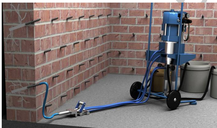
Рисунок 1- Наглядный пример инъекционной гидроизоляции кирпичной стены
