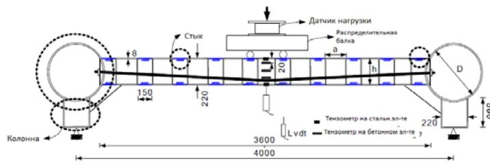
Рисунок 4 – Испытание постнапряженной коробчатой плиты, аналогичной создаваемой в методе опережающей крепи. Сеул, Республика Корея [3]
